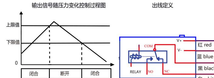
\*工作方式：当压力上升到设定的上限压力时，黑线和白线断开，当压力下降到下限压力时，黑线和白线之间导通。
