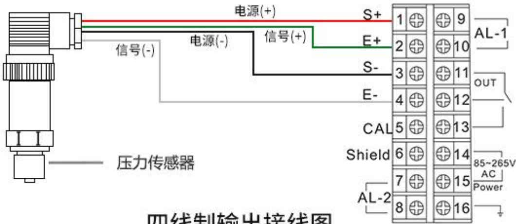
四线制输出接线图
