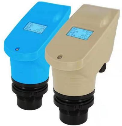
ULGL-101二线制超声波液位计是智能型非接触式液位测量仪表。具有安全、清洁、精度高、寿命长、稳定可靠、安装维护方便等特点,适用酸、碱、盐、防腐、高温等各种领域。可通过4~20mA或RS485(Modbus协议或其他定制协议)连接到显示表或各种DCS系统中,为工业的自动化运行,提供实时的液位数据。
