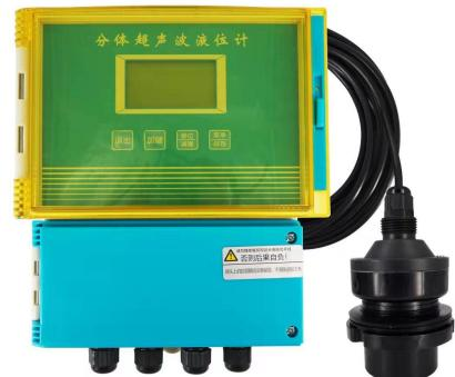
ULGL-102分体式超声波液位计是智能型非接触式液位测量仪表。具有安全、清洁、精度高、寿命长、稳定可靠、安装维护方便等特点，适用酸、碱、盐、防腐、高温等各种领域。可通过4~20mA或RS485(Modbus协议或其他定制协议)连接到显示表或各种DCS系统中，为工业的自动化运行，提供实时的液位数据。
