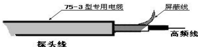
黑色热缩套管的屏蔽线是接 线路板上的传感器 --, 白色透明的高频线是接 线路板上的传感器+。
