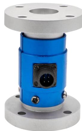
NJL-204系列静态扭矩传感器, 电阻应变为敏感元件和集成电路构成的一体产品, 精度高, 性能稳定可靠, 静态扭矩测量, 两端均为法兰盘连接。安装使用方便。扭矩传感器采用德国技术和生产设备及先进的检测设备。
