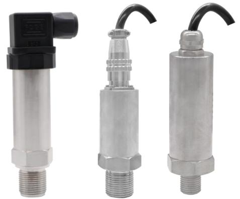
PTL503应变式压力传感器采用不锈钢整体构件，进口弹性体元件，高精度应变计及先进的工艺，具有灵敏度高、性能稳定、良好的抗冲击能力。接头采用17-4不锈钢 外管采用304不锈钢，结构小巧，紧凑，有良好的防潮能力和优异的介质兼容性。可测弱腐蚀性的液体、气体。
