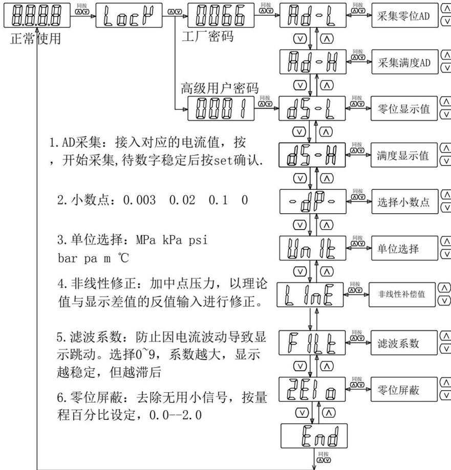
1. AD采集：接入对应的电流值，按，开始采集，待数字稳定后按set确认。
