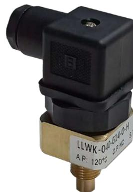
LLWK机械式定温式温度开关采用金属片原理，当温度达到设定值时，绕制成环形弯曲状的双金属片，一端受热膨胀出发内置机械装置，开关动作。
