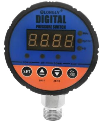
YL-801数显压力控制器为电子压力开关,集压力测量、显示、控制于一体的多功能智能开关。当压力达到预定值时输出控制信号,接通或关闭被控设备,实现自动化控制的目的,可作为液位控制器, 液压压力开关。
