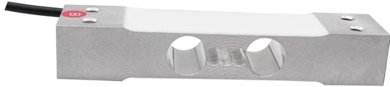
LCZ-301B悬臂梁式传感器弹性体采用剪切或弯曲悬臂梁结构, 一端固定, 一端受力, 外形高度低, 结构强度高。可用于各种拉伸力或压缩力的承载和测量。具有防尘密封、量程范围广、性能稳定可靠、安装使用方便等特点。适用于电子秤、衡器等各种测力、称重的工业自动化车辆控制系统。
