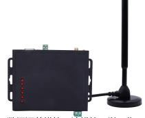
LZKB-101是针对于无线 LORA 通信的 子站模块而设计的网关/DTU 数据汇总模块,该模块可以工作在两种模式:即数据汇总模式和透传模式,数据汇总模式下可自动汇总各个子站模块的数据并存入自身寄存器,从而供上位机读取,也能将上位机的指令分发到各个子站模块执行,用户的上位机 PC 或者 PLC 只需要和 LZKB-101 主站模块交互数据即可而无需分别访问各个子站模块,极大节省了上位机资源,降低了上位机软件开发难度。透传模式下该模块可以直接透传上位机的指令到各个子站模块,也可以将各个子站模块的回复信息转发给上位机,透传模式下该模块将不再汇总上下行数据,仅仅具备数据双向转发功能。
